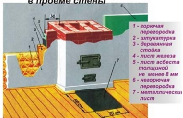
Устройство термоизоляционного слоя у деревянной стены
