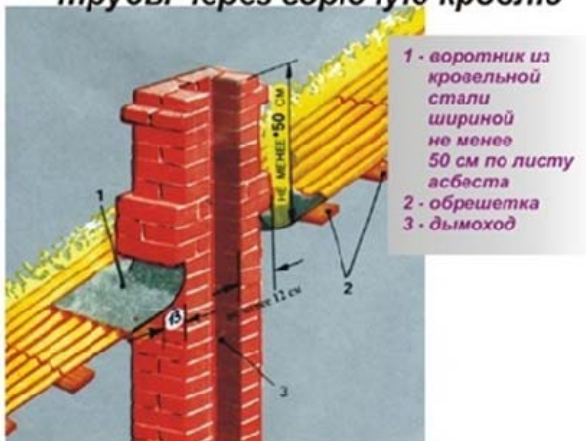
Устройство прохода дымовой трубы (разделки) в междуэтажном горючем перекрытии
